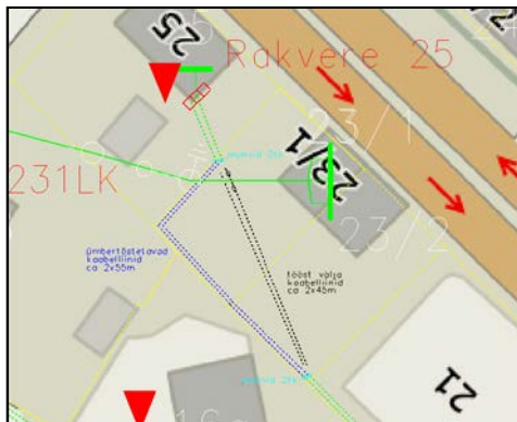
Skeem 3. Rakvere tn 23/1 ja Rakvere tn 23/2 kinnistute võrgu ümberehitus (alus: Elektrilevi OÜ Tehnilised tingimused võrkude ümberehituseks nr 248967).
